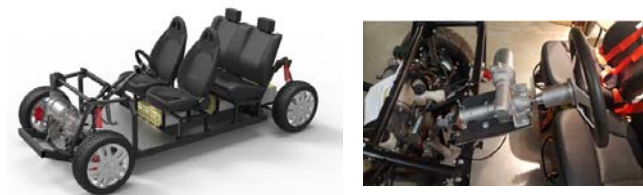
Figura 5: Chasis del vehículo y detalle de la dirección electrónica del volante.
