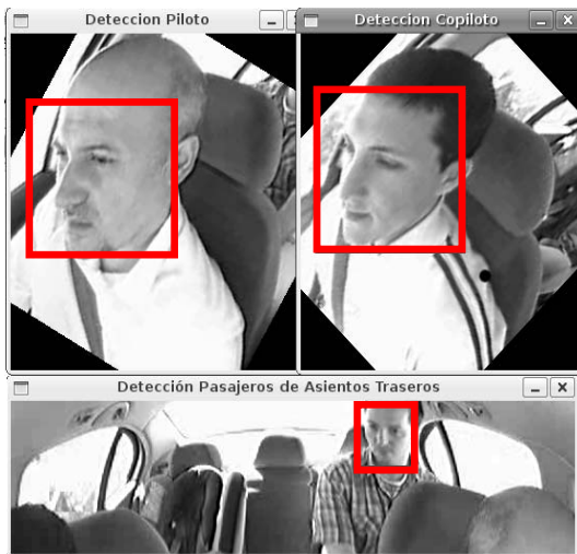
Fig. 7. Separación en regiones de una imagen. Reflexión y rotaciones en las regiones de piloto y copiloto tal como se explica en el apartado C de la sección IV. Detección de caras en las regiones.
