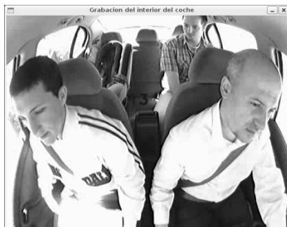
Fig. 8. Imagen original capturada por la cámara con el resultado de la detección de ocupantes visualizado como un número en el centro.
