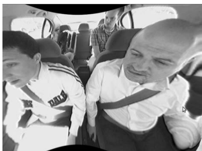
Fig. 5. Imagen 640x480 rectificada y escalada previamente para verla al completo. Los bordes quedan muy distorsionados tras la rectificación.
