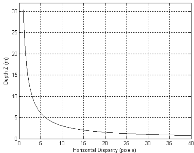
Figura 6.7: Profundidad en función de la disparidad
