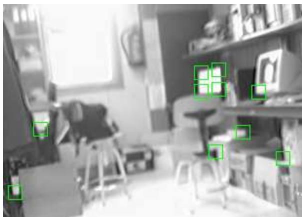
Figura 5.1: Ejemplo de extracción de características en una imagen
